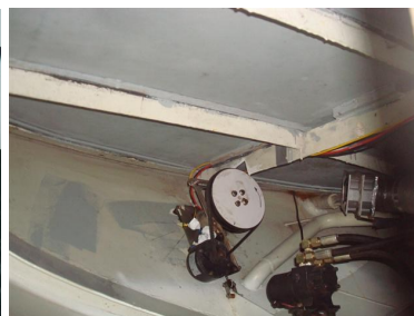
Sleepschroef met de generator onder het achterdek
